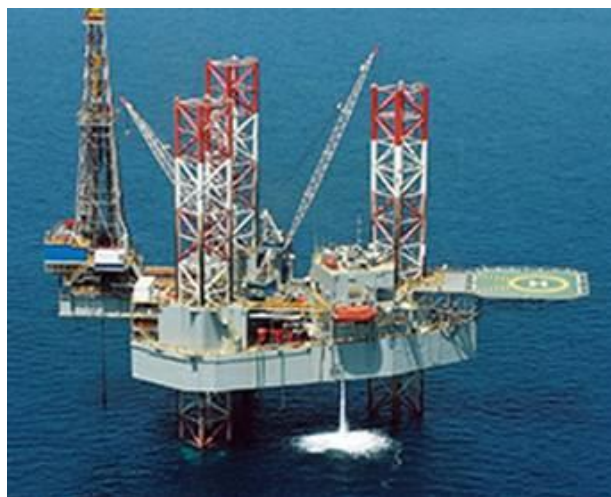
Figuur 2: Zelfheffend boorplatform
