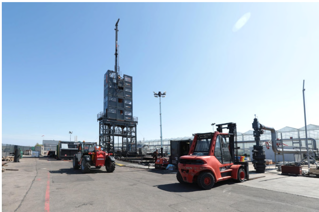
Figuur 3.3: Hydraulic Workover Unit van WellGear (voorbeeld in te zetten installatie voor de 'side track' boringen)
